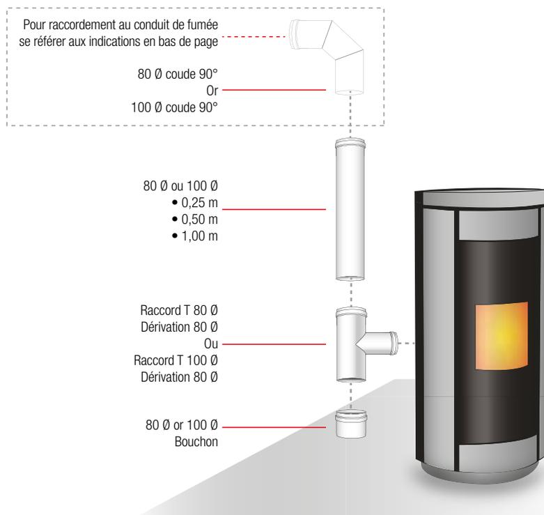
On évitera dès que possible d'installer des sections de conduits de cheminée à l'horizontale, ces derniers ne devant en aucun cas dépasser les deux (2) mètres linéaires et devant avoir une pente minimum de 5%, et devant être visibles, accessibles et démontables dans leur intégralité.
