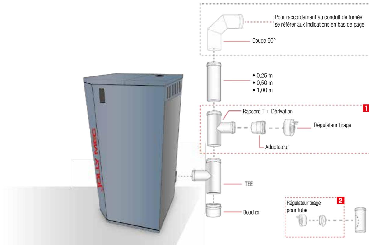
On évitera dès que possible d'installer des sections de conduits de cheminée à l'horizontale, ces derniers ne devant en aucun cas dépasser les deux (2) mètres linéaires et devant avoir une pente minimum de 5%, et devant être visibles, accessibles et démontables dans leur intégralité.
